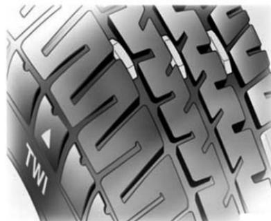
La profundidad mínima permisible de la rodada (1.6 mm) se alcanza cuando la banda de rodadura se haya desgastado hasta uno de los indicadores de desgaste (TWI). Su posición se indica mediante marcas en el costado.
