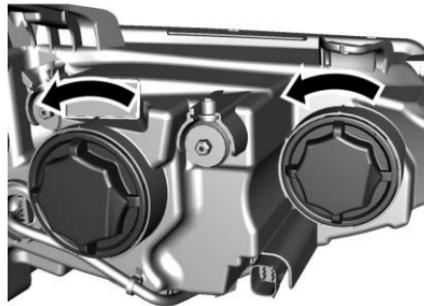
3. Retire la cubierta de acceso del foco del faro.
