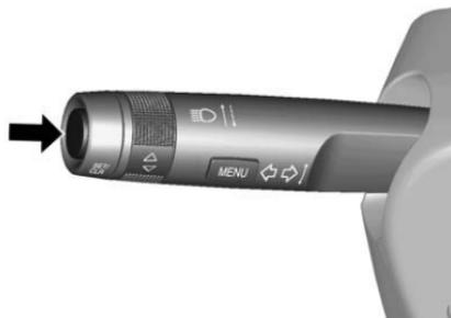
Presione **SET/CLR** para seleccionar una función o para confirmar un mensaje.
