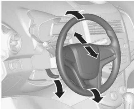
Desbloquee la palanca, ajuste el volante, después conecte la palanca y asegúrese que esté totalmente bloqueada.
