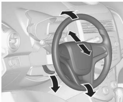
Desbloquee palanca, ajuste el volante, luego enganche la palanca y asegúrese de que esté completamente cerrada. No ajuste el volante con el vehículo en movimiento.
