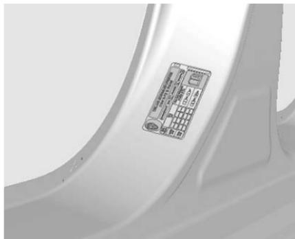
Etiqueta de presión de llantas en el marco de la puerta del conductor.
