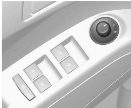
Seleccione el espejo exterior relevante girando el control hacia la izquierda (L) o derecha (R). Luego mueva el control para ajustar el espejo.
