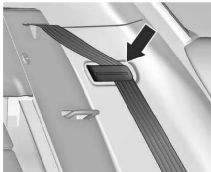
3. Coloque los cinturones de seguridad de los asientos exteriores en las guías para el cinturón.
