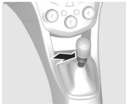
Para enganchar la reversa, con el vehículo detenido, jale hacia arriba en el anillo de la palanca selectora para enganchar la velocidad.
