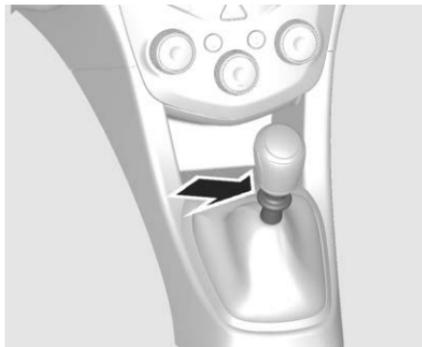
Para enganchar la reversa, con el vehículo detenido, jale del anillo en la palanca selectora y enganche la velocidad.
