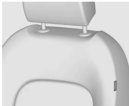
El sistema de bolsa de aire lateral consiste en una bolsa de aire en cada descansabrazos del asiento delantero.
