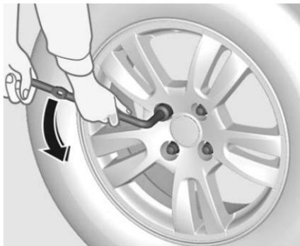
2. Despliegue la llave de la rueda e instálela asegurando que se ubique firmemente y afloje cada tuerca de rueda media vuelta.
