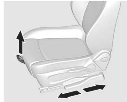
Para mover el asiento hacia adelante o atrás, jale la palanca y deslice el asiento a la posición deseada.
