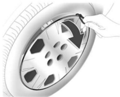
1. Retire la cubierta de la rueda con un destornillador y retírela.
