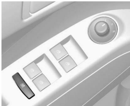
Presione el interruptor
