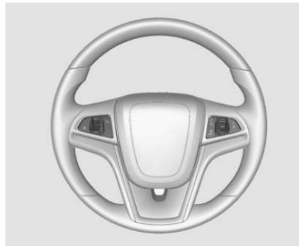
El sistema de infoentretenimiento y el control crucero se puede operar por medio de los controles del volante.
