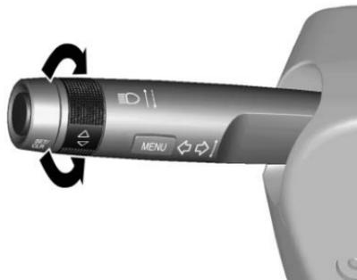
Para operar la computadora de viaje, gire la rueda de ajuste en la palanca de direccionales.
