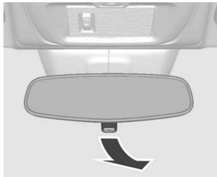
Para reducir el deslumbramiento, ajuste la palanca debajo de la carcasa del espejo.
