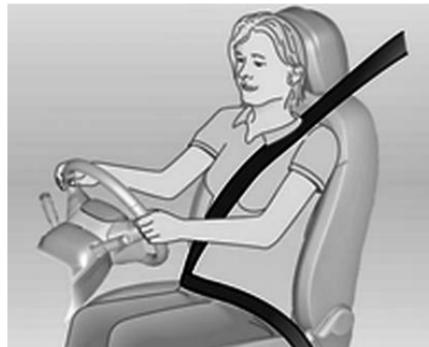
Los cinturones se bloquean durante una aceleración o desaceleración intensa del vehículo para seguridad de los ocupantes.
