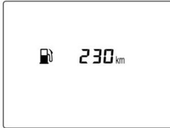
Este modo indica la distancia de conducción calculada para vaciarse a partir del combustible actual en el tanque de combustible.
