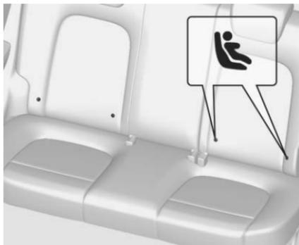
2. Localice las dos posiciones de ancla inferior. La ubicación de cada anclaje inferior está identificada con una marca circular en el extremo inferior del respaldo trasero.
