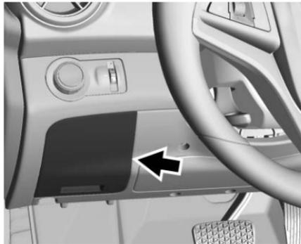
La caja de fusibles del tablero de instrumentos se encuentra en el lado inferior del tablero de instrumentos del lado del conductor.
